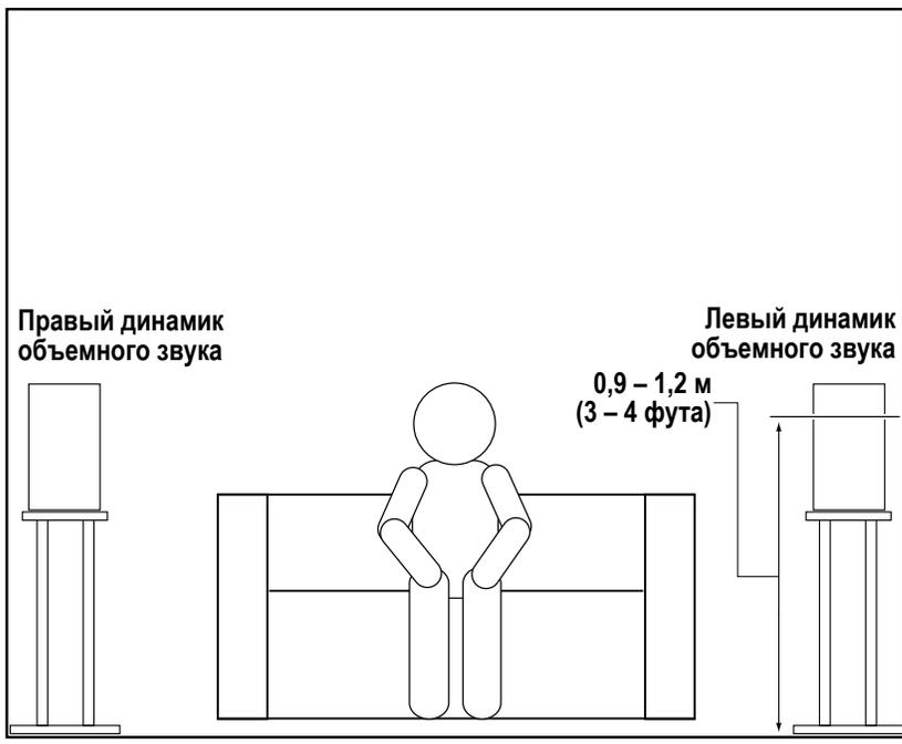
**LOFT40/LOFT30 — КАНАЛЫ ОБЪЕМНОГО ЗВУКА (7.1-КАНАЛЬНАЯ СИСТЕМА)**
