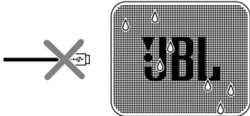
本製品は、防水規格 IPX7 相当の仕様となっています。一時的 (30 分) に一定水深 (1m) の条件に水没しても内部に浸水しない「防浸形」です。
