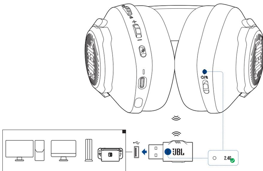
1. Conecta este adaptador USB inalámbrico de 2,4 GHz en un puerto USB-A de tu PC, Mac, consola PS4/PS5 o consola Nintendo Switch™.
