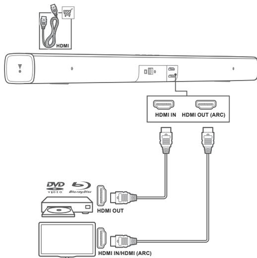
Подключите цифровое устройство, например ТВ-приставку, проигрыватель DVD/Blu-ray или игровую консоль к звуковой панели через разъем HDMI. Когда вы подключите устройства таким образом и запустите файл или игру,
