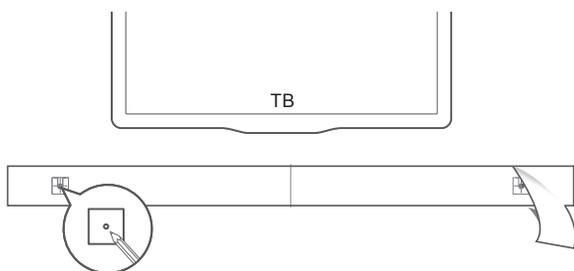
Прикрутите настенные крепления в месте отметок, прикрутите резьбовые крепления к задней части звуковой панели, затем повесьте звуковую панель на стену.
