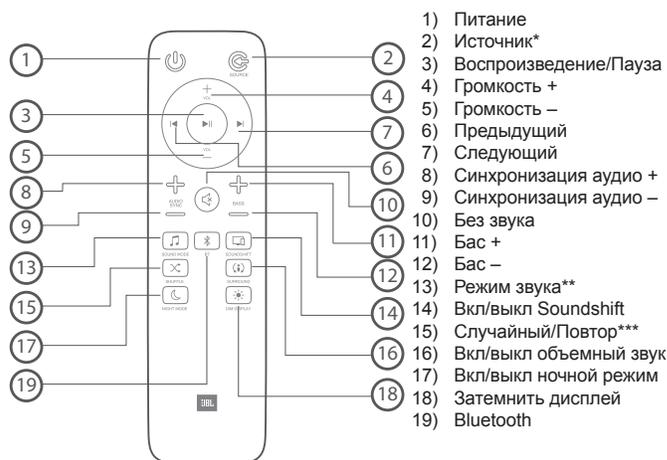
\* Переключение между HDMI ARC/HDMI 1/Optical/AUX/Bluetooth/USB
