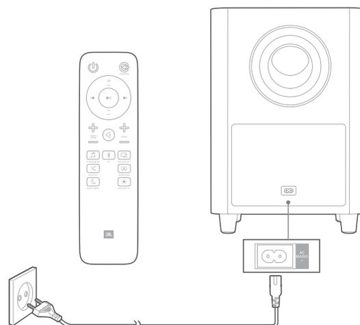
Беспроводной сабвуфер автоматически подключится к звуковой панели после включения обоих устройств. Если сабвуфер включен и подключен, светодиодные индикаторы будут непрерывно гореть белым.
