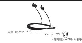
充電中は、ステータスインジケーターが赤く点灯します。 充電が完了するとステータスインジケーターは消灯します。充電が完 了したら充電用ケーブルを外してください。
