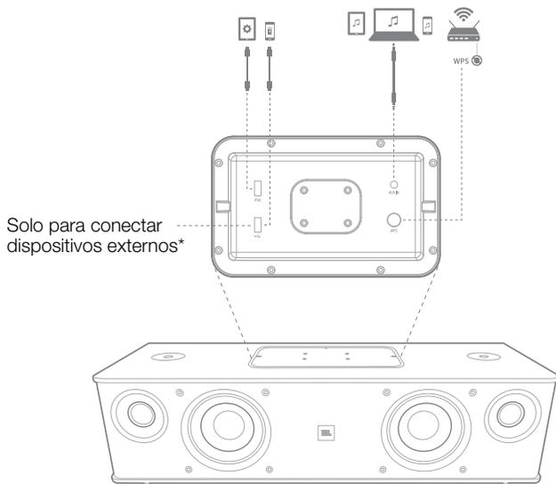
**Puertos USB:** los puertos USB disponibles en el sistema de audio JBL Authentic L8 permiten la comunicación con aplicaciones y la carga de dispositivos, como teléfonos móviles o dispositivos iOS. El sistema puede cargar otros
