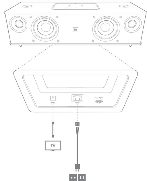
**Entrada Óptica (Óptico):** si su televisor, reproductor de discos o sintonizador de cable/satélite dispone de una salida digital óptica, utilice un cable óptico (no suministrado) para conectarlo aquí.
