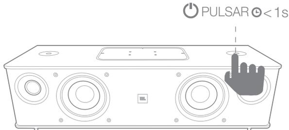
Para poner el sistema en modo de espera, vuelva a pulsar el botón de encendido/apagado.
