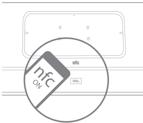
El panel superior del sistema JBL Authentic L8 incluye los siguientes controles en la parte central, cubiertos por una tapa. Para acceder a los controles, retire la tapa:
