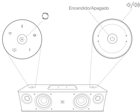
**Botón de encendido/apagado:** para encender el sistema, pulse el botón de encendido/apagado. El indicador de encendido/apagado del sistema cambiará a blanco y se mantendrá encendido mientras el sistema esté en modo operativo. Para poner el sistema en modo de espera, vuelva a pulsar el botón de encendido/apagado. Para restaurar la configuración a los valores predeterminados de fábrica, mantenga pulsado el botón de encendido/apagado durante al menos 10 segundos.
