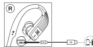
充電中は、電源 / Bluetooth インジケーターが赤く点灯し、充電が完了するとインジケーターが消灯します。充電が完了したら充電用ケーブルを外してください。
